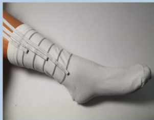
Monitorování otoků na základě změny el. odporu.
